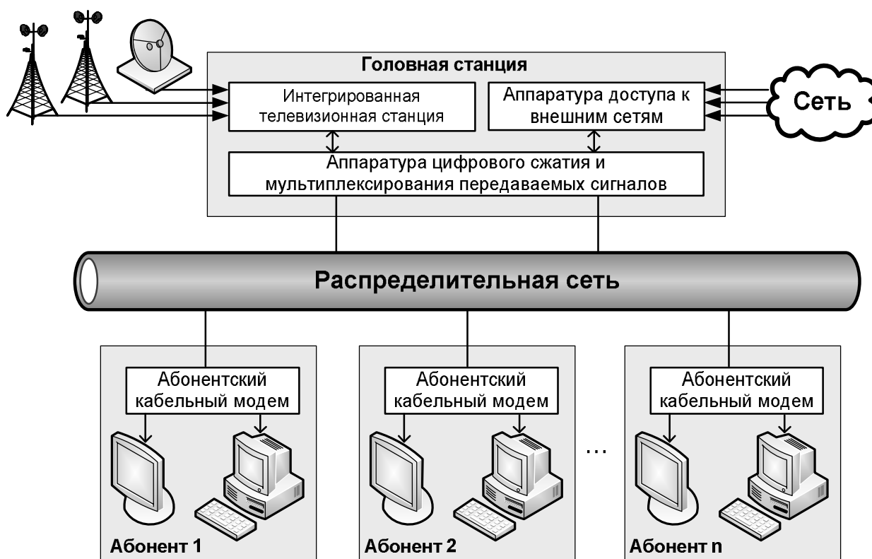
Рис. 5.6. Функциональная схема цифровой мультисервисной сети кабельного телевидения интерактивного типа [20]
