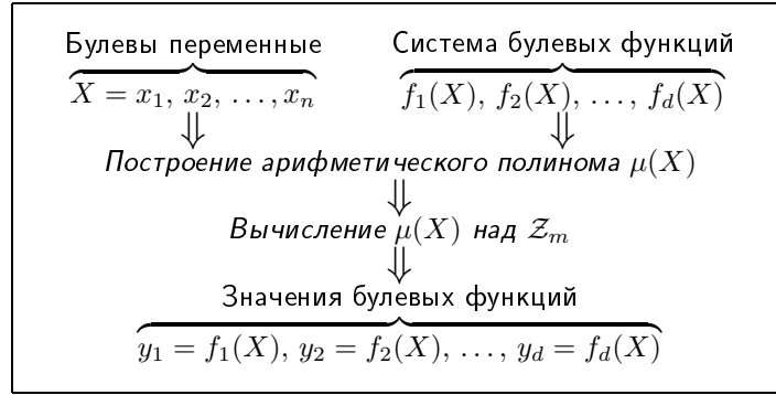
Рис. 2.4: Схема вычисления произвольной системы булевых функций над \mathbb{Z}_m
