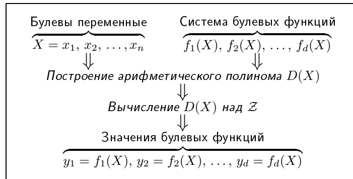
Рис. 1.1: Схема вычисления произвольной системы булевых функций над кольцом \mathcal{Z}
