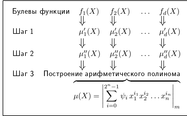
Рис. 2.3: Пояснения ко второму варианту алгоритма получения (2.1)
