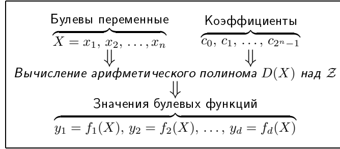
Рис. 1.2: Схема вычисления заданной системы булевых функций над кольцом \mathcal{Z}
