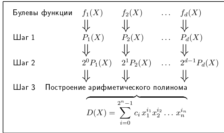
Рис. 1.3: Схема алгебраического метода построения арифметического полинома D(X)
