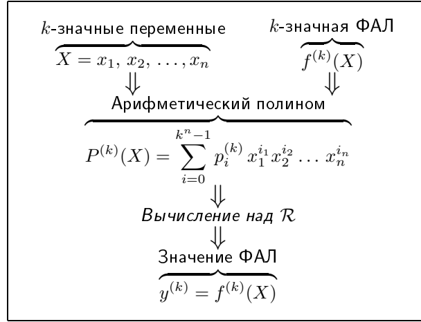
Рис. 5.1: Схема вычисления произвольной k -значной ФАЛ над \mathcal{R}
