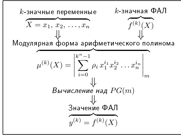
Рис. 5.4: Схема вычисления произвольной k -значной ФАЛ над PG(m)
