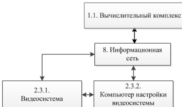
Рис. 5. Тракты передачи данных – с видеоизображениями, между вычислительным комплексом и видеосистемой (пример 1)
