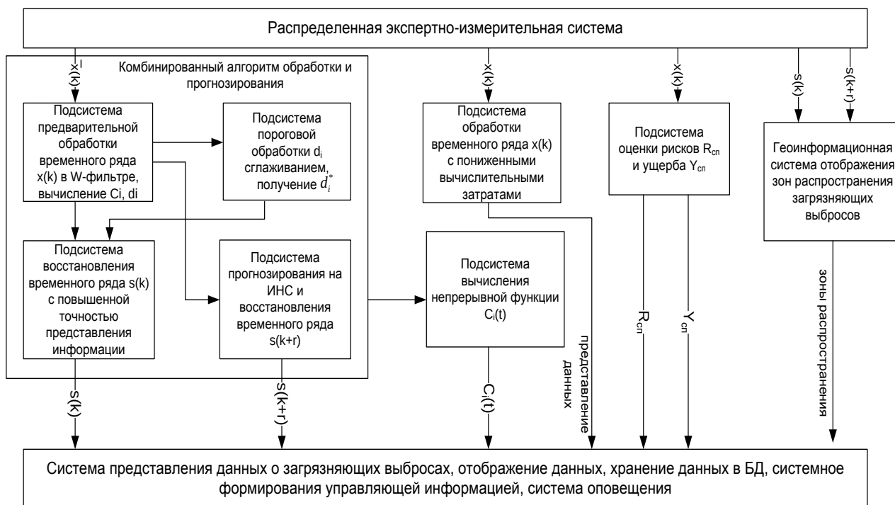
Рис. 10. Структурная схема программно-аппаратной части автоматизированной системы мониторинга
