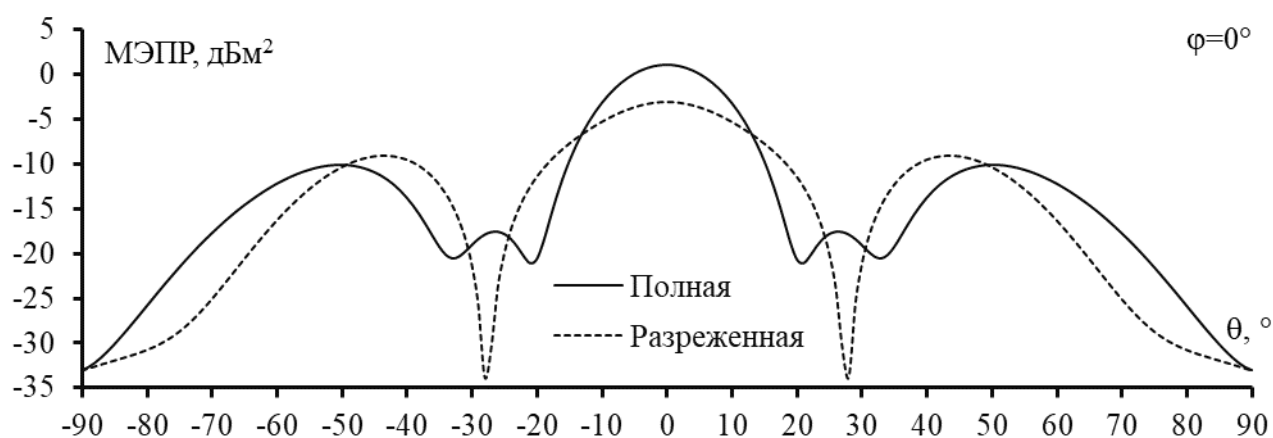
Рис. 6. Вычисленные МЭПР в плоскости \varphi = 0^\circ на частоте 2,4 ГГц для антенн из полной и разреженной ПС
