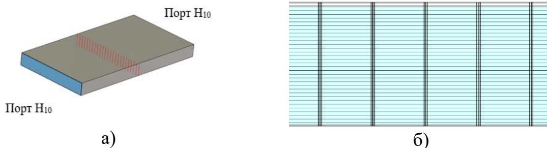
Рис. 10. Волноводный тракт с тройками нитей: а) общий вид модели волноводного тракта; б) вид тракта в поперечном сечении
