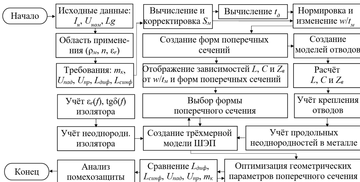
Рис. 3. Методика проектирования ШЭП с проводными отводами
