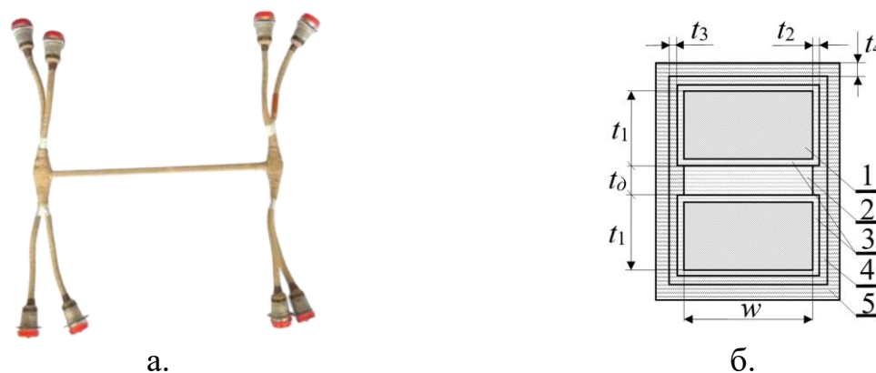
Рис. 1. ШЭП КА (а) и геометрическая модель её поперечного сечения (б)
