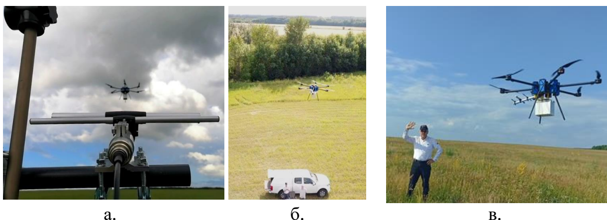
Рис. 16. Измерительный комплекс АО РК «Вектор» 2023 г. а) и б) – аппаратура в ходе испытаний, в) БПЛА с бортовой аппаратурой в режиме зависания и прицеливания
