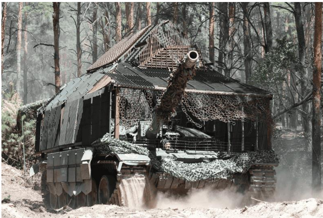
Рис. 15. Танк, оборудованный «кустарной» защитой из металлических листов, решеток и цепей на металлическом несущем каркасе
