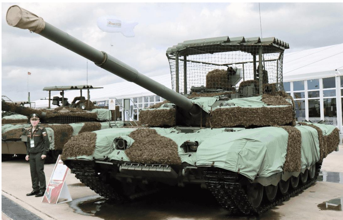
Рис. 25. Танк, с штатной защитой в верхней полусфере
