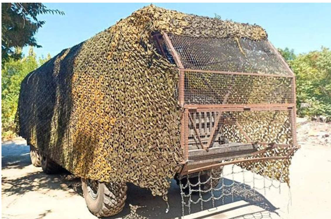
Рис. 28. Грузовой автомобиль, оборудованный «кустарной» защитой из металлических решеток и маскировочной сетей на металлическом каркасе
