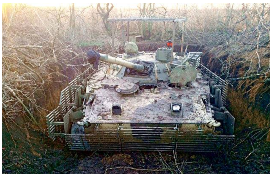
Рис. 24. БМП-3, оборудованный штатной защитой из противоккумулятивных решётчатых экранов по периметру и в верхней полусфере
