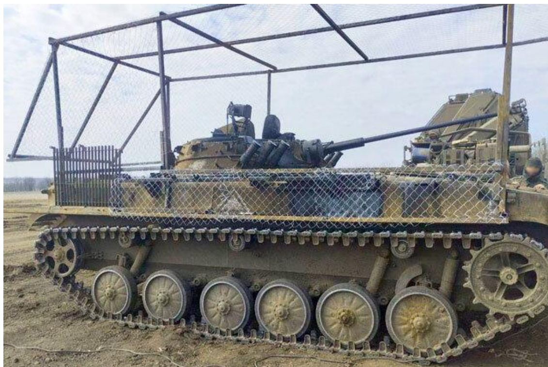
Рис. 19. БМП-2, оборудованная «кустарной» защитой из сетки-рабицы на металлическом каркасе
