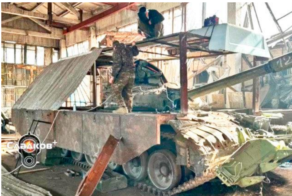
Рис. 16. Процесс оборудования танка «кустарной» защитой из металлических листов на металлическом несущем каркасе
