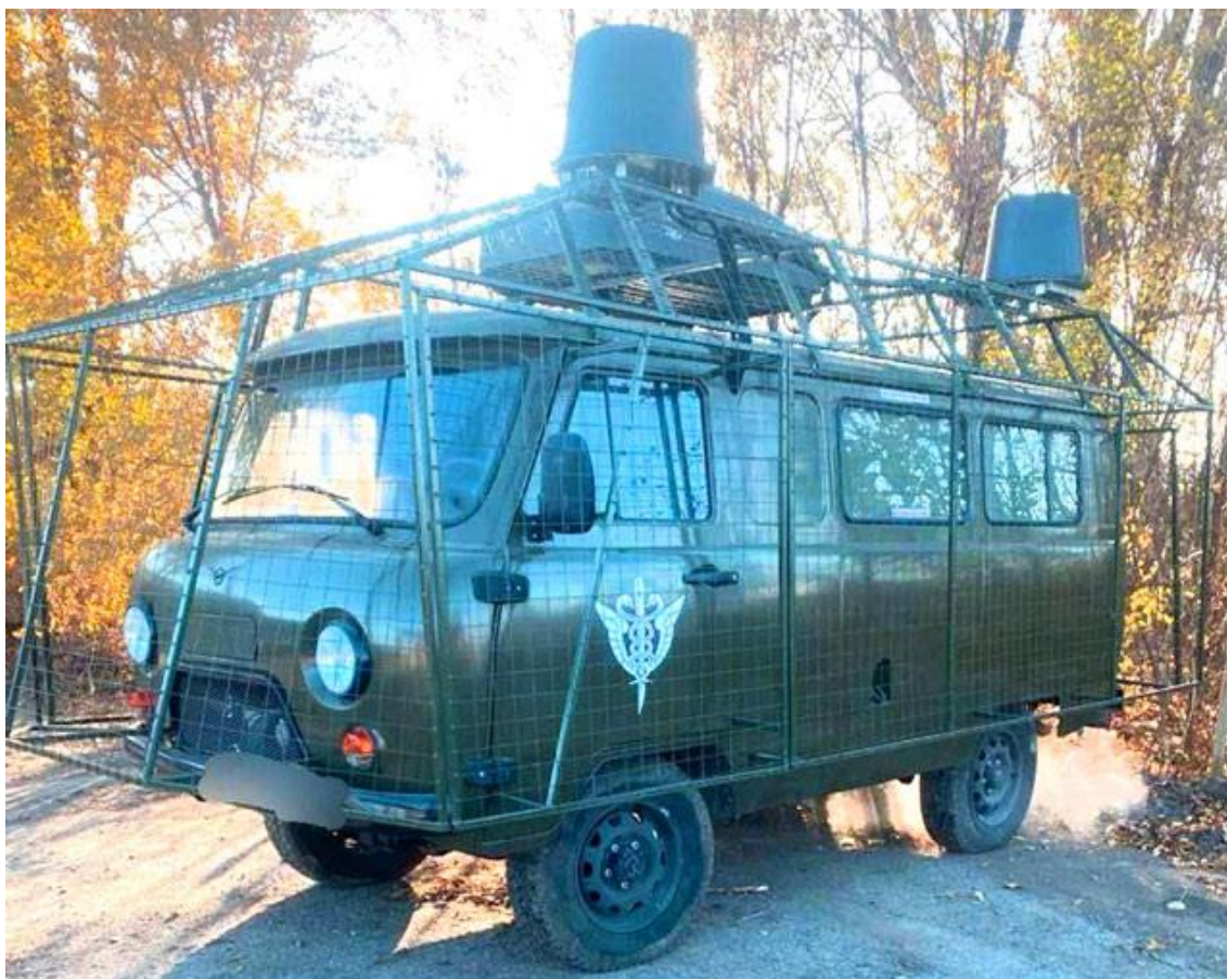
Рис. 27. УАЗ СГР, оборудованный «кустарной» защитой из сетки-рабицы на металлическом каркасе
