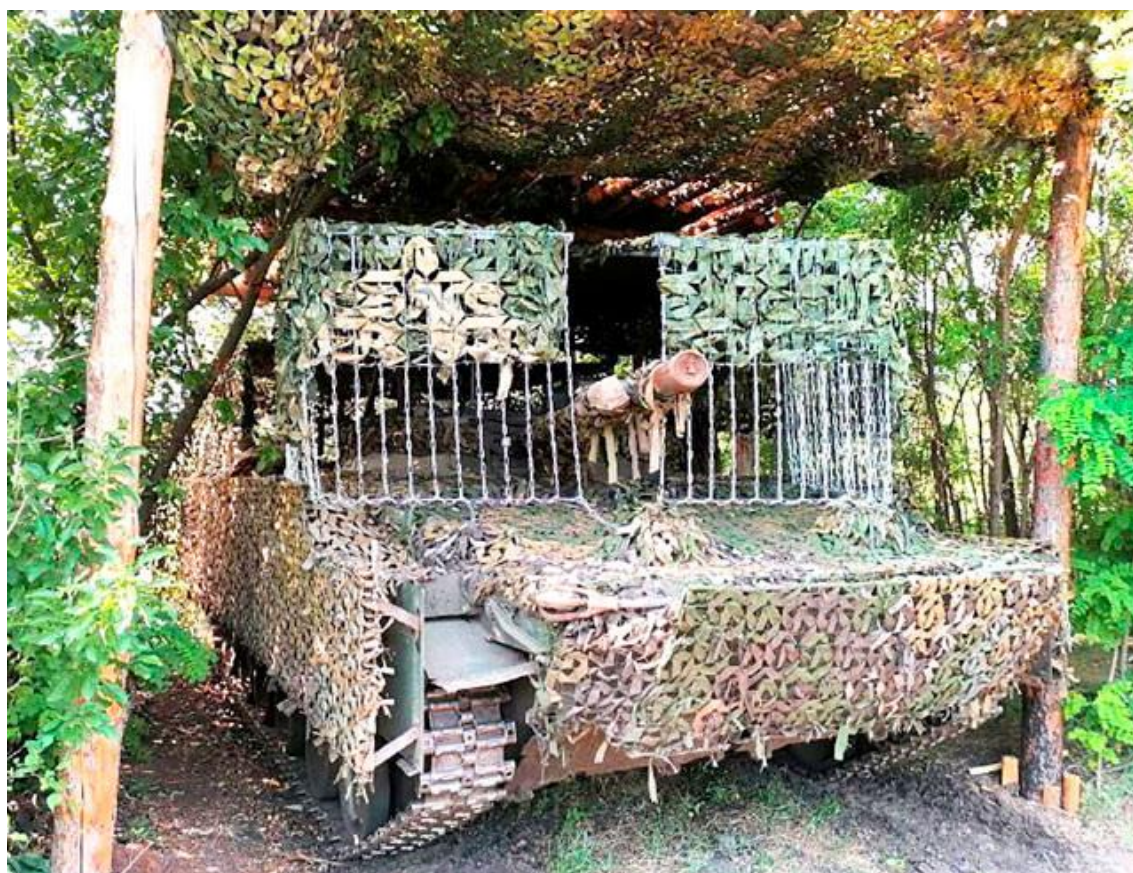
Рис. 20. БМП-2, оборудованный «кустарной» защитой из металлических и маскировочных сетей, цепных заграждений на металлическом каркасе
