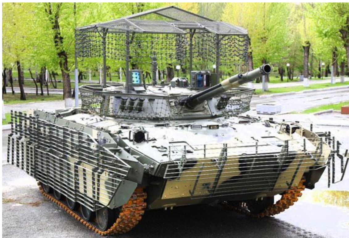
Рис. 23. БМП-4, оборудованный штатной защитой из противоккумулятивных решётчатых экранов по периметру и в верхней полусфере
