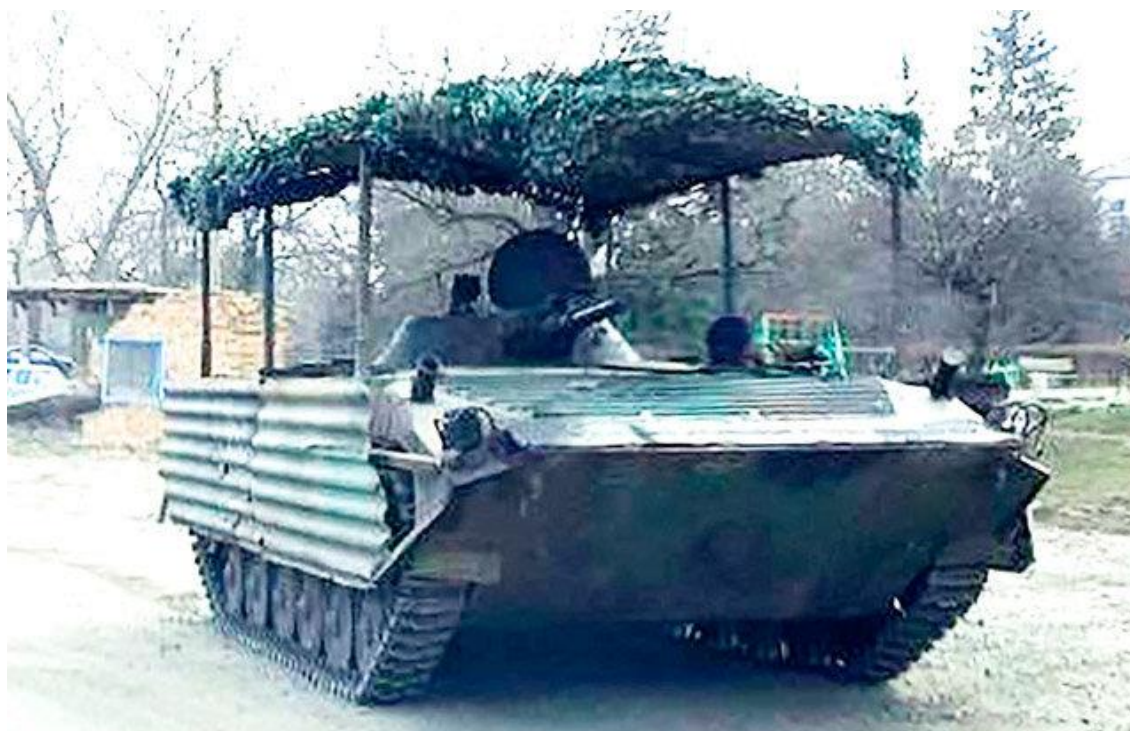
Рис. 18. БМП-1, оборудованный «кустарной» защитой из металлических листов, сетки-рабицы и маскировочных сетей на металлическом каркасе
