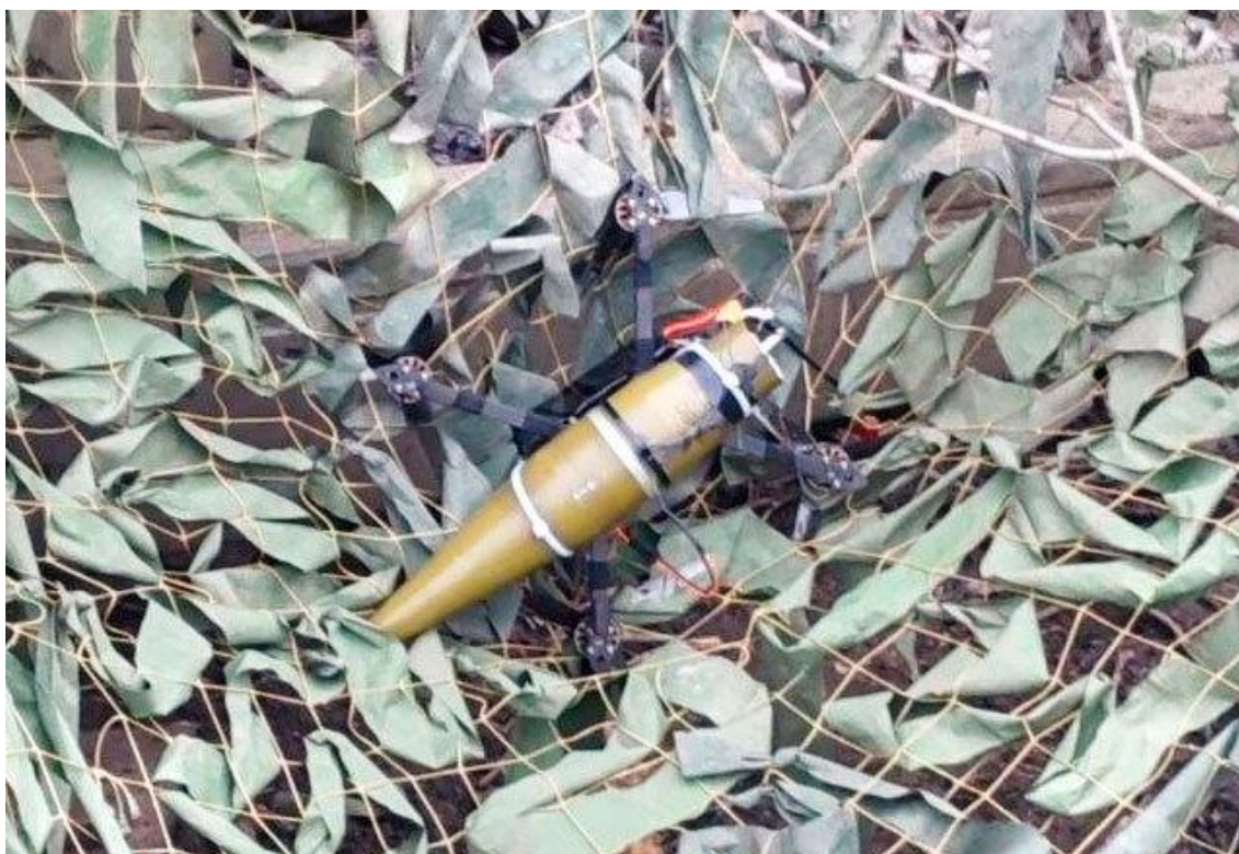
Рис. 12. FPV-БПЛА, застрявший в маскировочной сети
