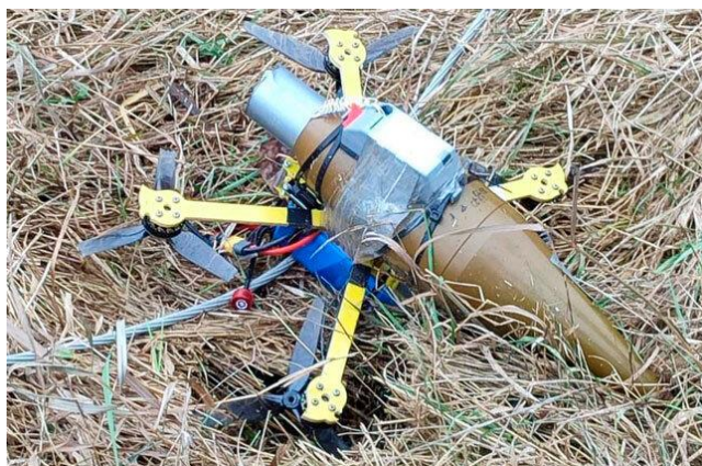
Рис. 9. FPV-БПЛА с кумулятивной боевой частью от РПГ-7
