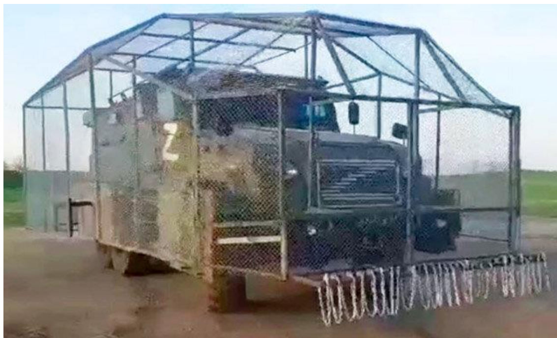
Рис. 29. Бронеавтомобиль, оборудованный «кустарной» защитой из металлических решеток на металлическом каркасе
