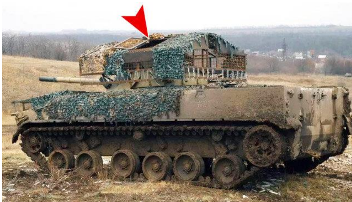
Рис. 21. БМП-3, оборудованный «кустарной» защитой из сетки-рабицы и маскировочной сети на металлическом каркасе. Предусмотрен специальный откидной люк в решётчатом навесе
