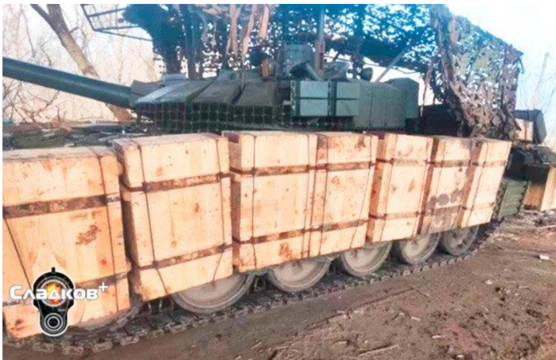
Рис. 17. Танк, оборудованный «кустарной» защитой из деревянных ящиков, сетки-рабицы и маскировочных сетей на металлическом каркасе
