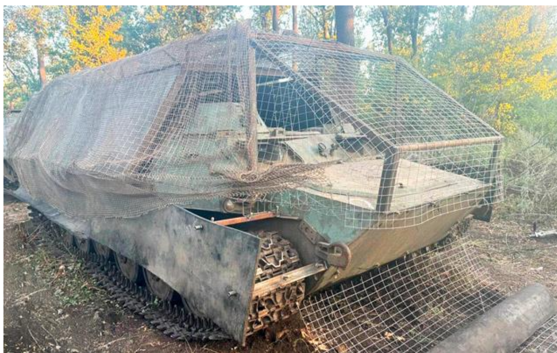
Рис. 26. МТЛБ, оборудованная «кустарной» защитой из металличе- ческих листов и сетей, волейбольных сетей на металлическом каркасе
