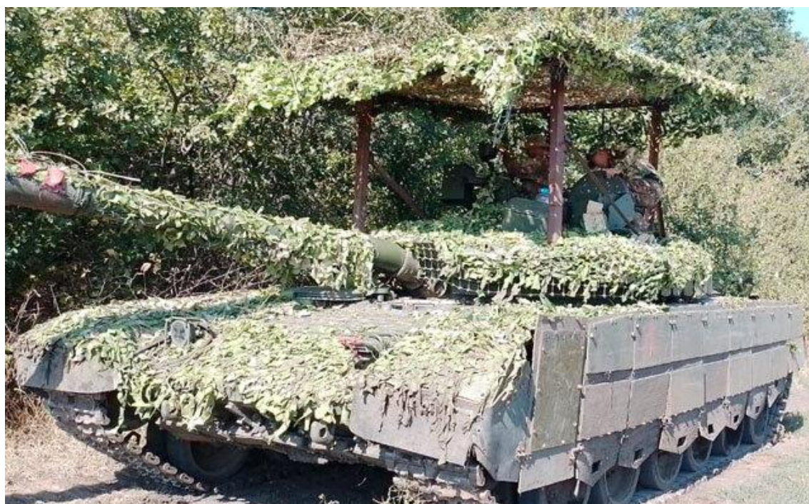
Рис. 22. Танк, оборудованный «кустарной» защитой из сетки-рабицы и маскировочной сети на металлическом каркасе
