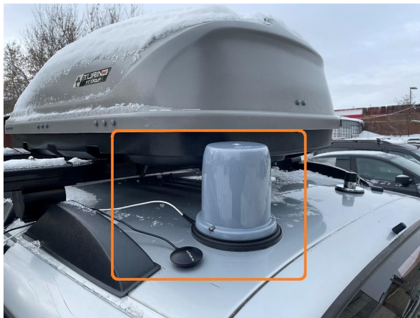
Рис. 7. Размещение приемной и навигационной антенн на крыше автомобиля
