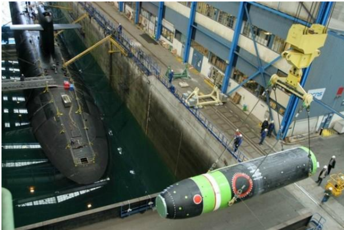
Рис. 2.2. Погрузка БРПЛ М51 на ПЛАРБ типа Triomphant
