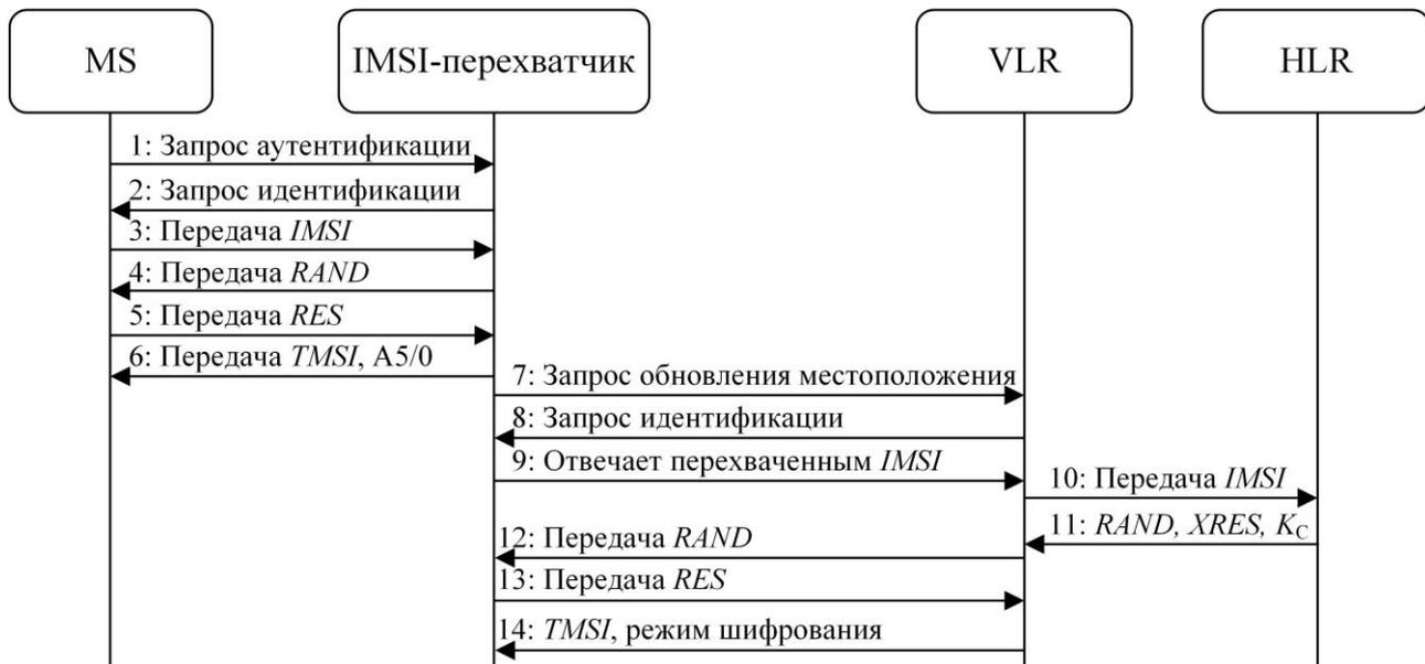
Рис. 5. Процедура работы IMSI-перехватчика в сети стандарта GSM
