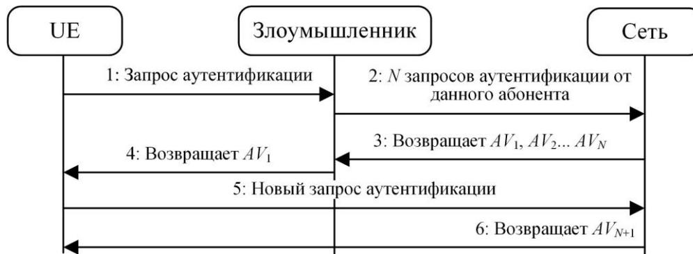
Рис. 13. Процедура рассинхронизации порядковых номеров аутентификации
