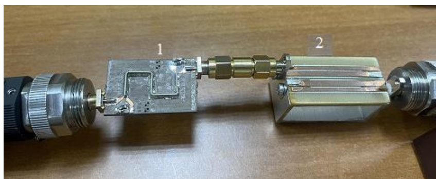
Рис. 12. Каскадное включение неотражающего фильтра 1 и ППФ отражающего типа 2
