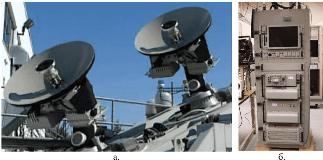
Рис. 8. Морские АТ NMT: а) антенная группа; б) связное оборудование [30]
