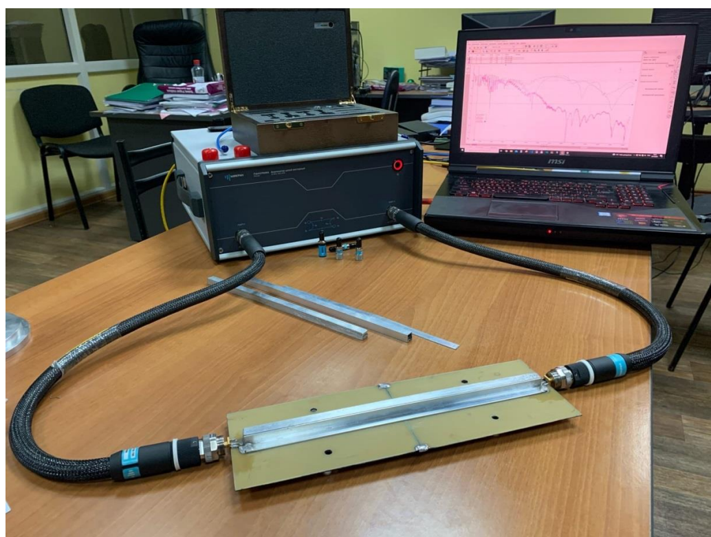
Рис. 11. Векторный анализатор электрических цепей «Панорама» P4226 и макет МФ с уголковым пассивным проводником
