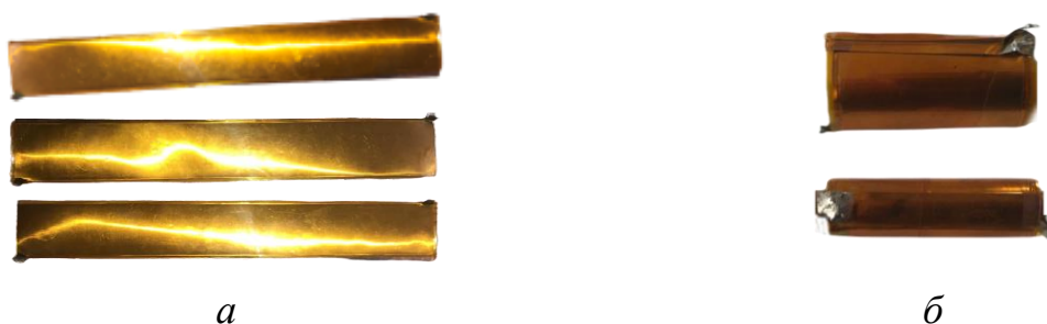
Рис. 25. Прототипы прямоугольной (а) и спиральной (б) шин питания с изоляторами из полиимида
