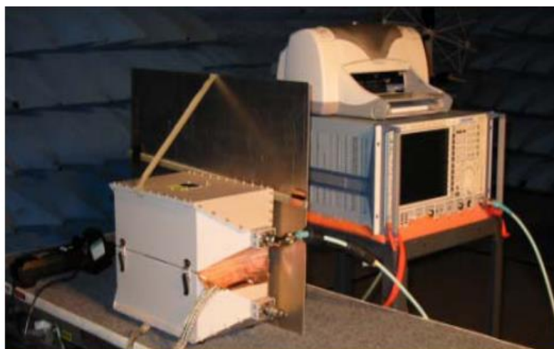
Рис. 11. Установка для измерения ЭМИ, генерируемого имитатором ЭСР
