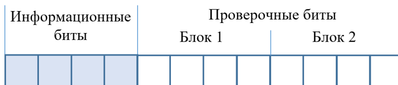
Рис. 6. Структура кодового слова турбокода
