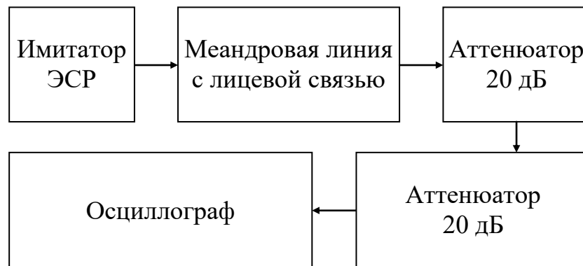
Рис. 17. Схема экспериментальной установки для проведения натурных испытаний
