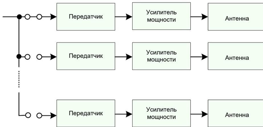
Рис. 12. Переключение сигнала между передатчиками (число передатчиков и усилителей мощности равно числу антенн)
