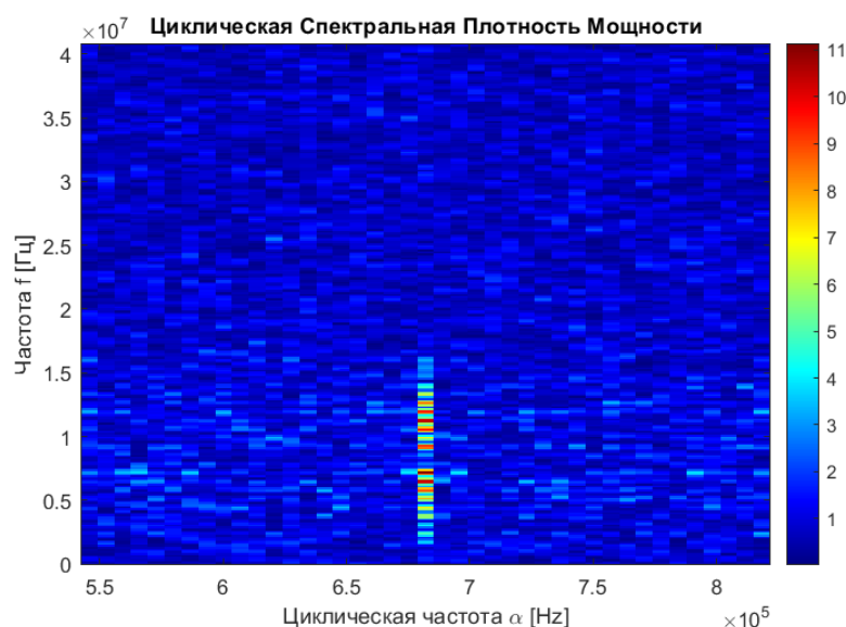
Рис. 7. Результаты анализа состояния радиоэфира с помощью ЦСПМ
