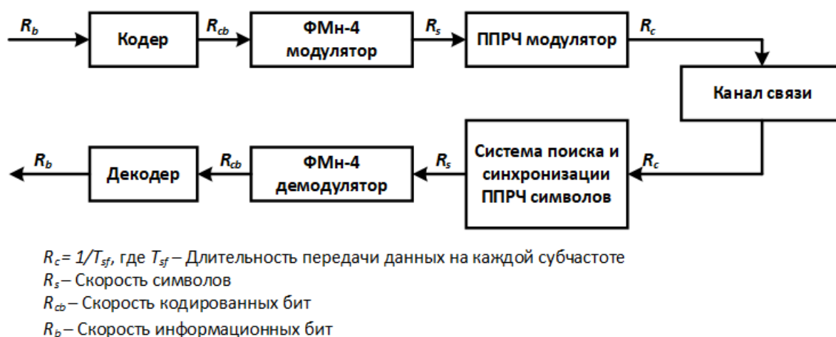
Рис. 2. Система связи с внутрисимвольной ППРЧ
