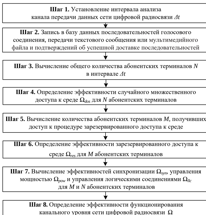
Рис. 7. Методика оценки эффективности функционирования канального уровня сети цифровой радиосвязи
