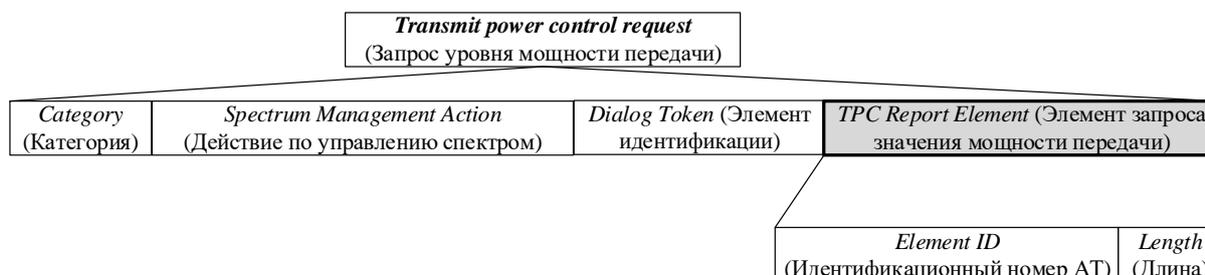
Рис. 7. Структура кадра запроса уровня мощности передачи «*Transmit power control request*»
