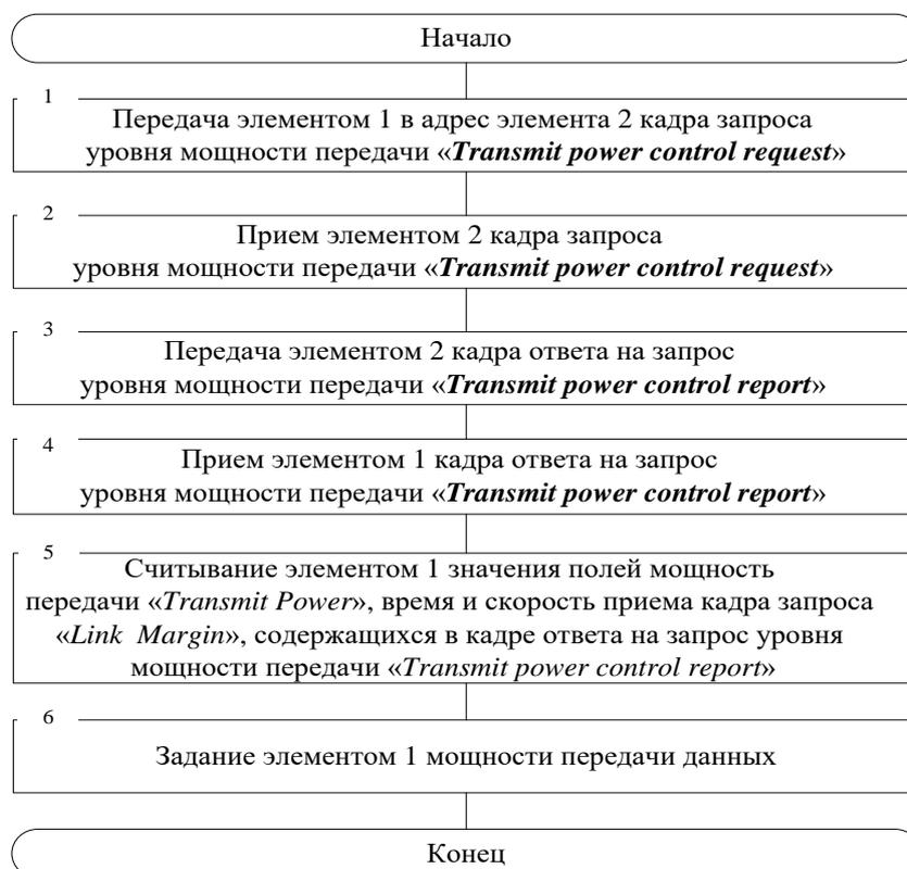
Рис. 6. Алгоритм определения мощности передачи данных между двумя равноправными элементами в сетях стандартов IEEE 802.11s и IEEE 802.11p
