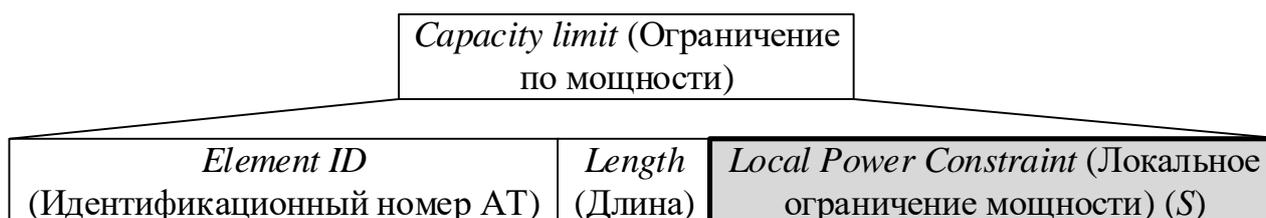
Рис. 5. Структура поля ограничение по мощности «Capacity limit» синхронизирующего кадра «Beacon»
