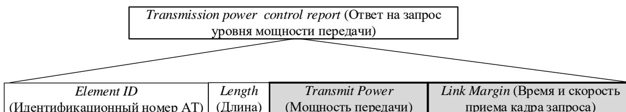
Рис. 8. Структура поля ответа на запрос значения мощности передачи «*Transmission power control report*» кадра ответа на запрос уровня мощности передачи «*Transmission power control report*»
