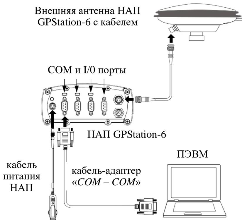
Рис. 8. Схема измерительного стенда
