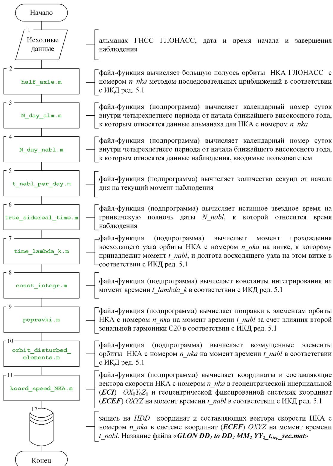
Рис. 4. Блок-схема алгоритма моделирования орбитального движения НКА СРНС ГЛОНАСС
