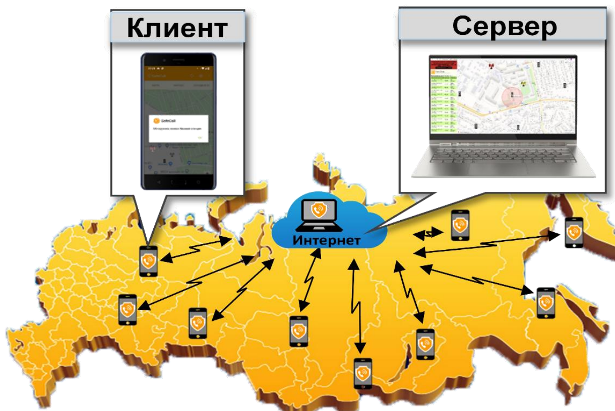
Рис. 8. Состав системы противодействия несанкционированному доступу к информации абонентов сотовой связи
