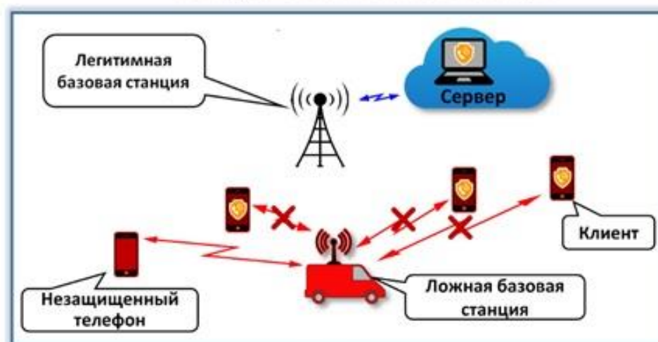
Этап 2 Блокирование канала утечки информации абонентов сотовой связи
