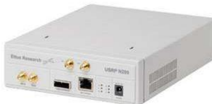
Рис. 4. Внешний вид ложной базовой станции на SDR-платформе фирмы «Ettus Research»
