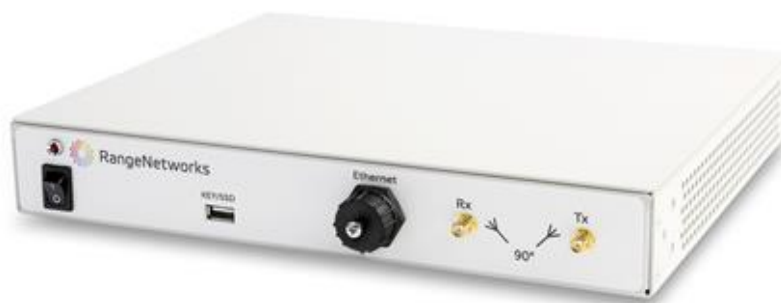
Рис. 3. Внешний вид ложной базовой станции «Open BTS development kit» фирмы «Range Networks»
