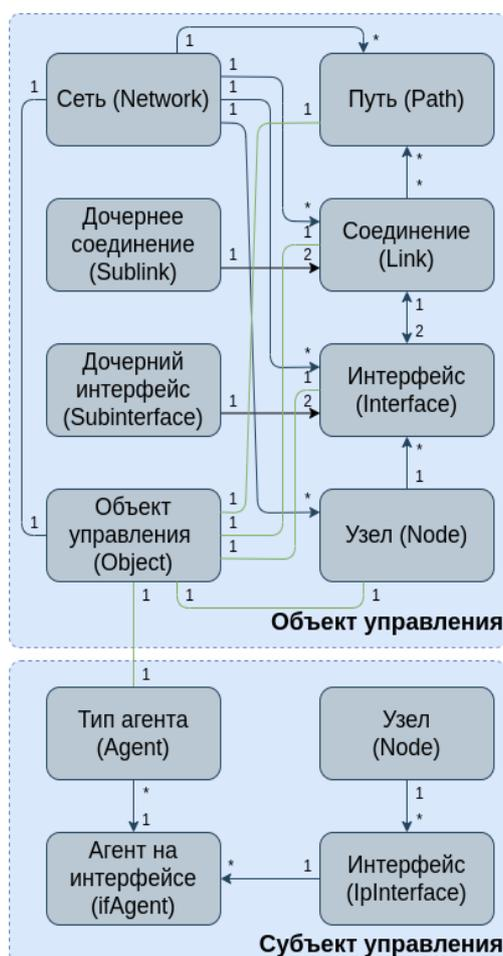
Рис. 3. Субъект-объектная модель подсистемы мониторинга ИТКС ОП типа «Сущность-связь»
