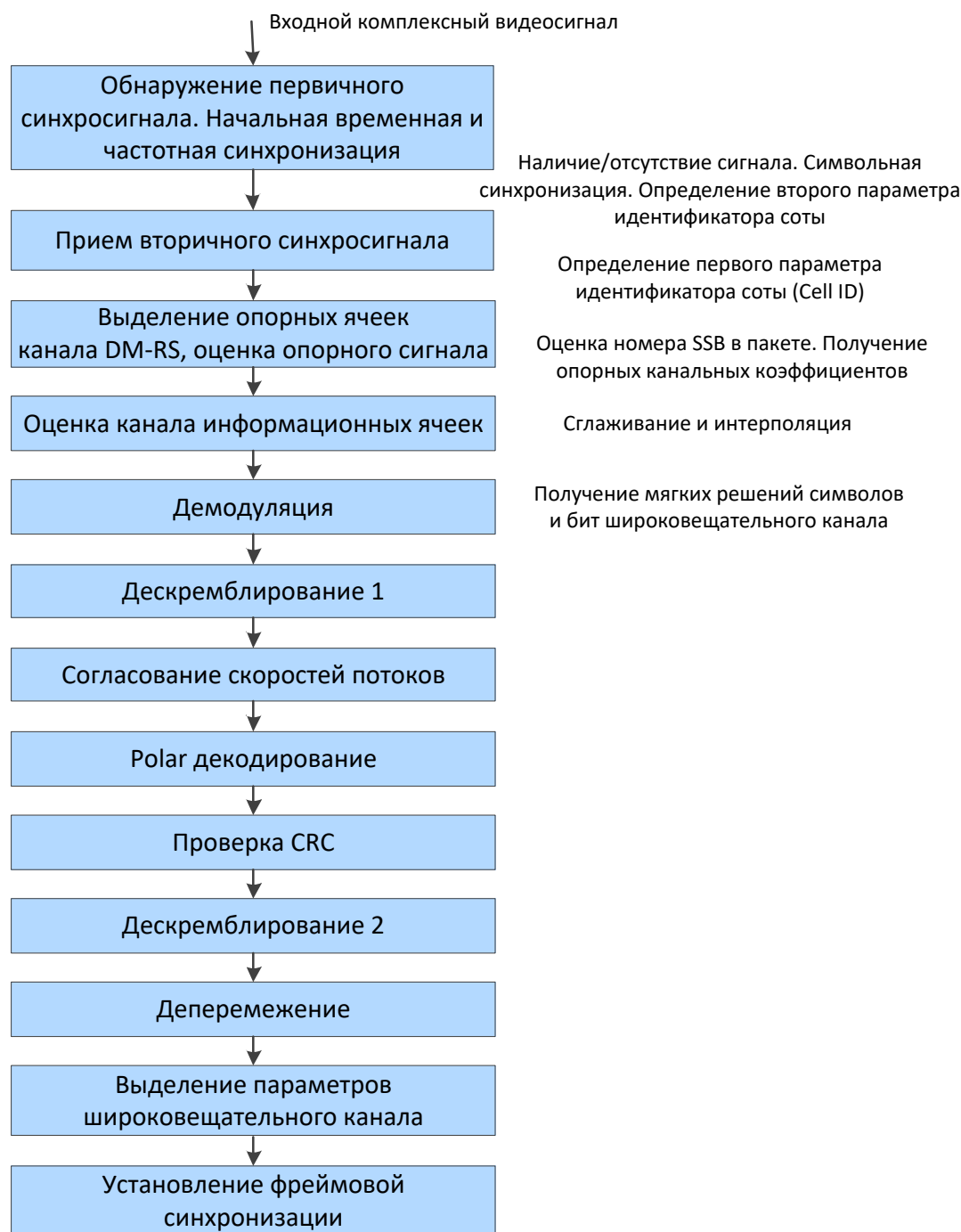
Рис. 4. Схема обнаружения синхроблоков и приема широковещательного канала
