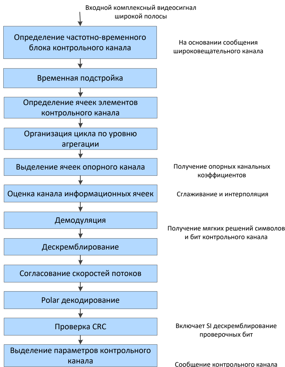
Рис. 9. Схема приема контрольного канала
