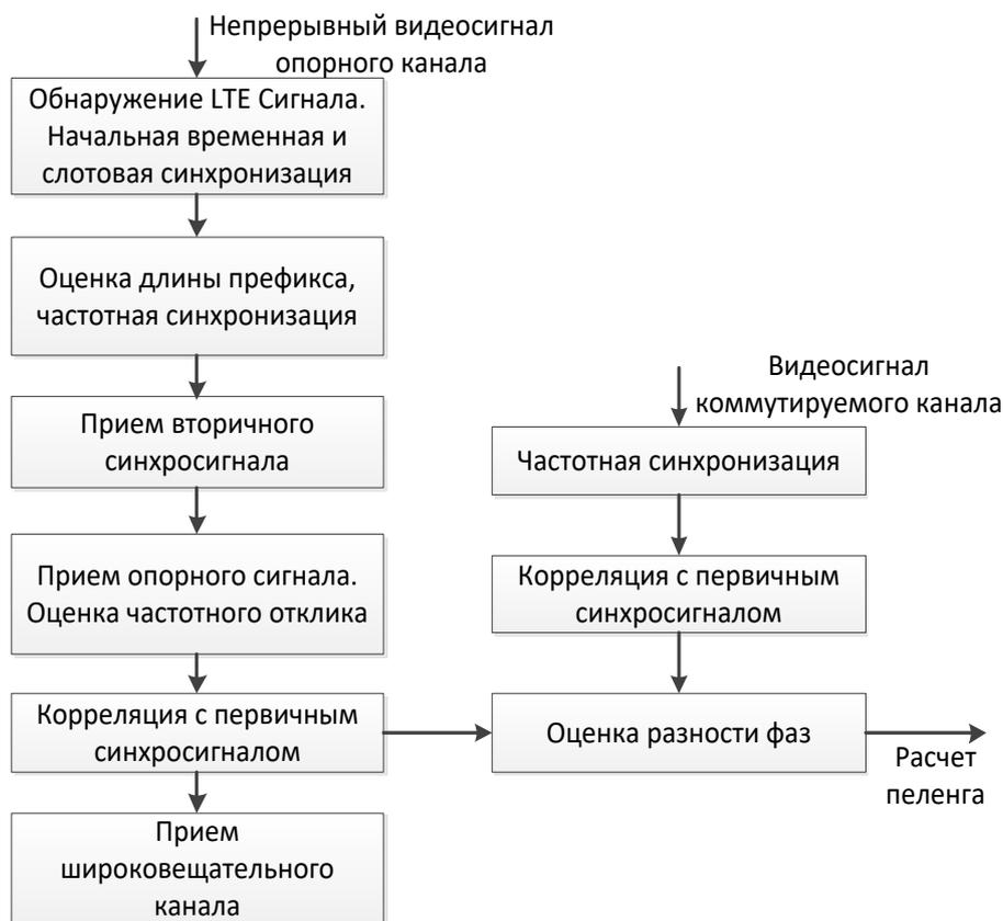
Рис. 4. Блок-схема пеленгования LTE сигнала
