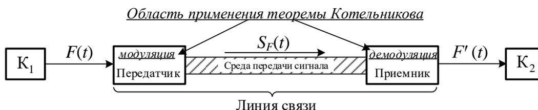
Рис. 1. Графическое представление условий решения задачи в 30-е годы XX века.  $K_1$  и  $K_2$  – первый и второй корреспонденты;  $F(t)$  – исходный непрерывный сигнал, передаваемый  $K_1$ ;  $S_F(t)$  – сигнал, модулированный  $F(t)$ , передаваемый в среде передачи;  $F'(t)$  – восстановленный непрерывный сигнал, получаемый  $K_2$
