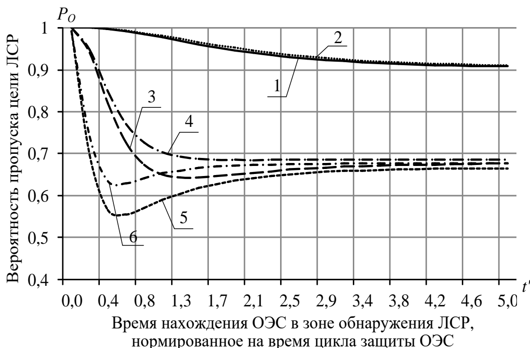
Рис. 3. Зависимости вероятности пропуска цели ЛСР от t' для: 1, 2 – одноэтапного поиска; 3, 4 – двухэтапного поиска; 5, 6 – комбинированного поиска; 2, 4, 6 – быстродействие ОЭС увеличено в два раза
