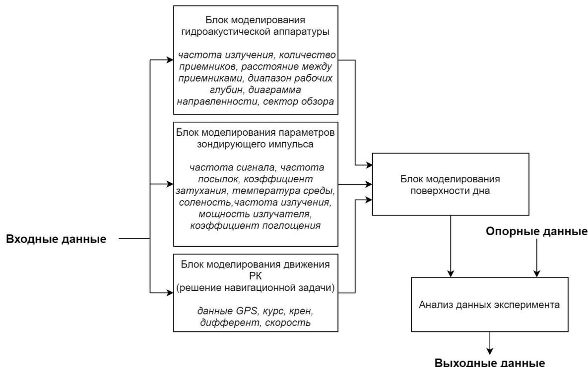
Рис. 1. Структурная схема разработанной имитационной модели
