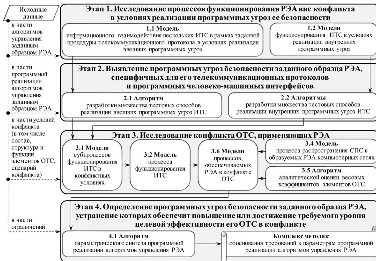
Рис. 4. Технологическая схема процесса обеспечения конфликтной устойчивости программной реализации алгоритмов управления РЭА
