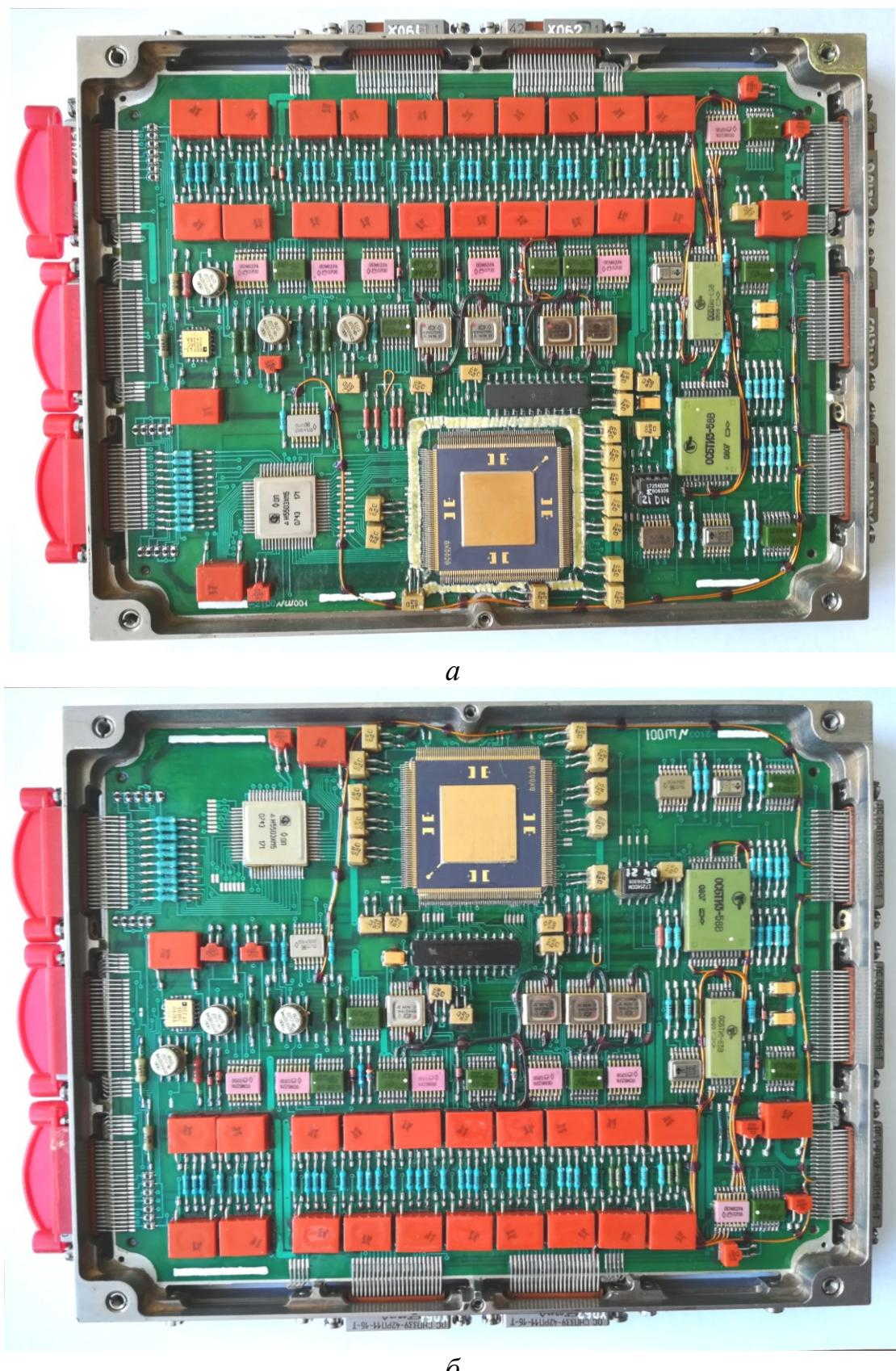
Рис. 2. Фотографии резервируемой и резервной печатных плат на сторонах А (а) и Б (б) основания
