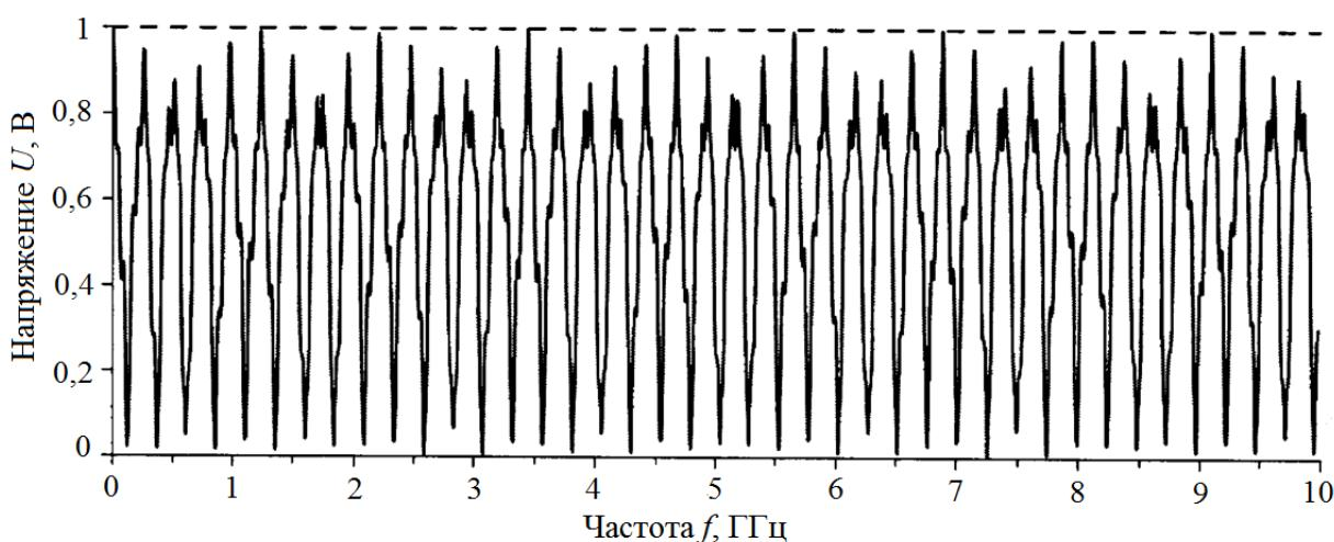
Рис. 8. Частотные отклики на гармоническое воздействие связанный линии (—) и одиночной МПЛ (—)
