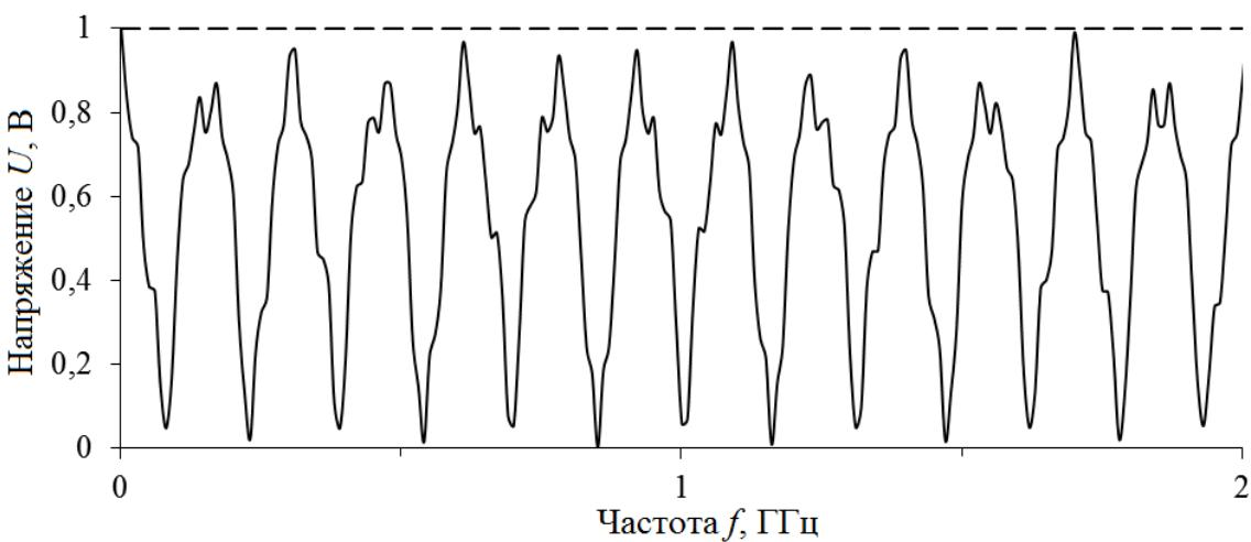
Рис. 16. Частотные отклики на гармоническое воздействие рассматриваемой структуры (—) и одиночной МПЛ (---)
