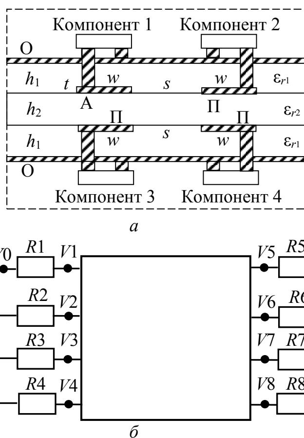
Рис. 23. Поперечное сечение структуры печатной платы, реализующей способ трехкратного резервирования, где проводники А – активный; О – опорный; П – пассивный ( $a$ ). Принципиальная схема ( $b$ )
