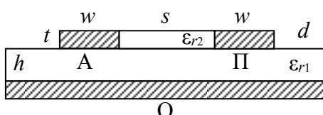
Рис. 6. Поперечное сечение структуры связанных линий,
