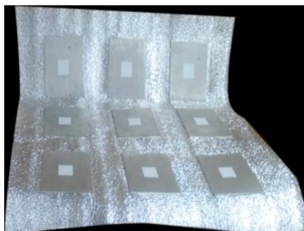
Рис. 1. Внешний вид гибкого термоуправляемого покрытия с ТЭМ
