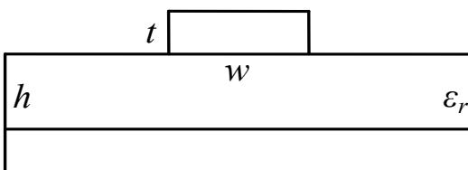
Рис. 1. Поперечное сечение микрополосковой линии
