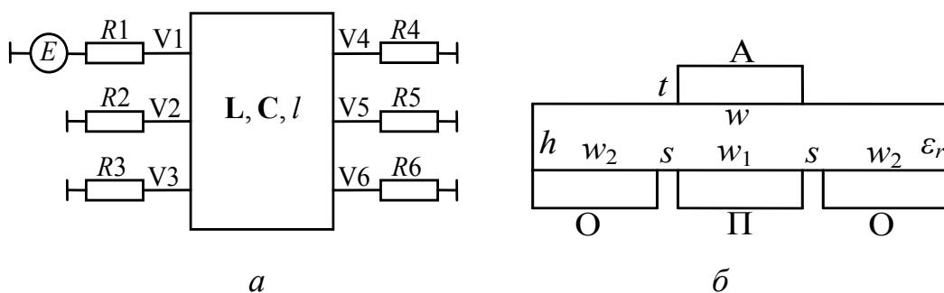
Рис. 4. Схема включения (а) и поперечное сечение МФ (б).
