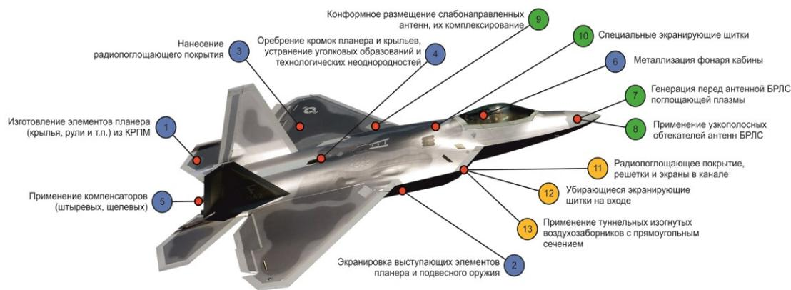
Рис. 1. Меры по снижению радиолокационной заметности воздушного судна
