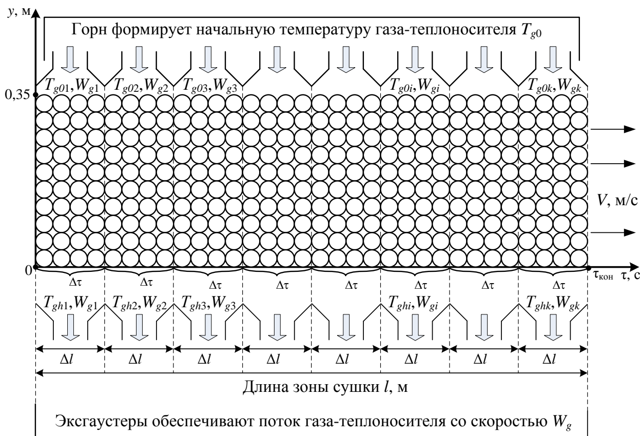
Рис. 2. Дискретизация времени пребывания окатышей в зоне сушки длиной l конвейерной обжиговой машины 0 \leq \tau \leq \tau_{\text{кон}} в зависимости от прохождения отдельных вакуум-камер длиной \Delta l , в которых формируется вектор управляющих параметров X_i(T_{g0i}, W_{gi}) .
