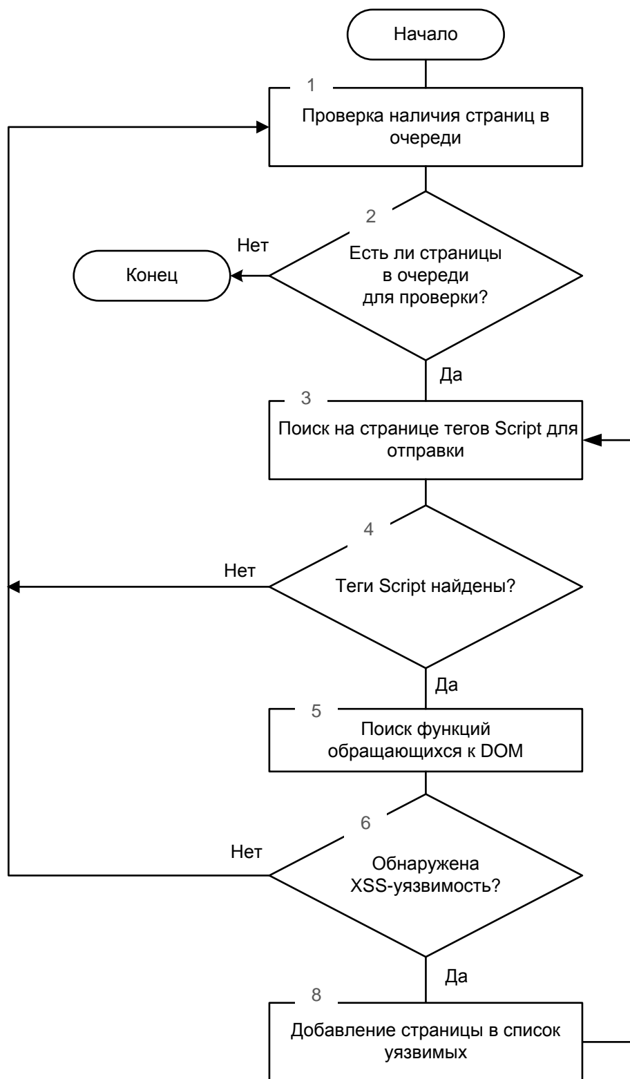
Рис. 4. Блок-схема алгоритма поиска «XSS-уязвимостей, эксплуатирующих DOM»
