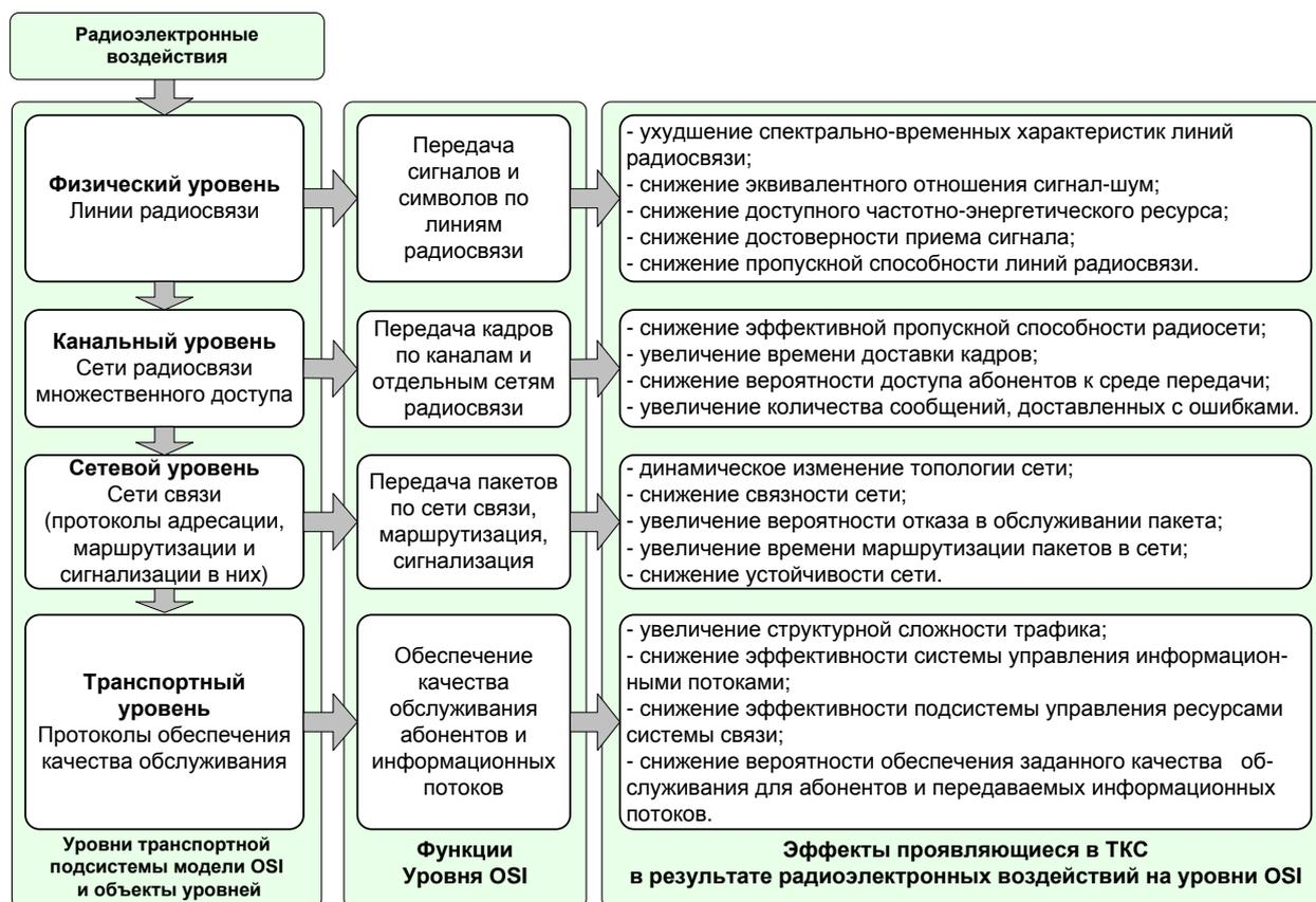
Рис. 7. Эффекты, возникающие на различных уровнях функционирования ТКС в результате РЭ ИТВ
