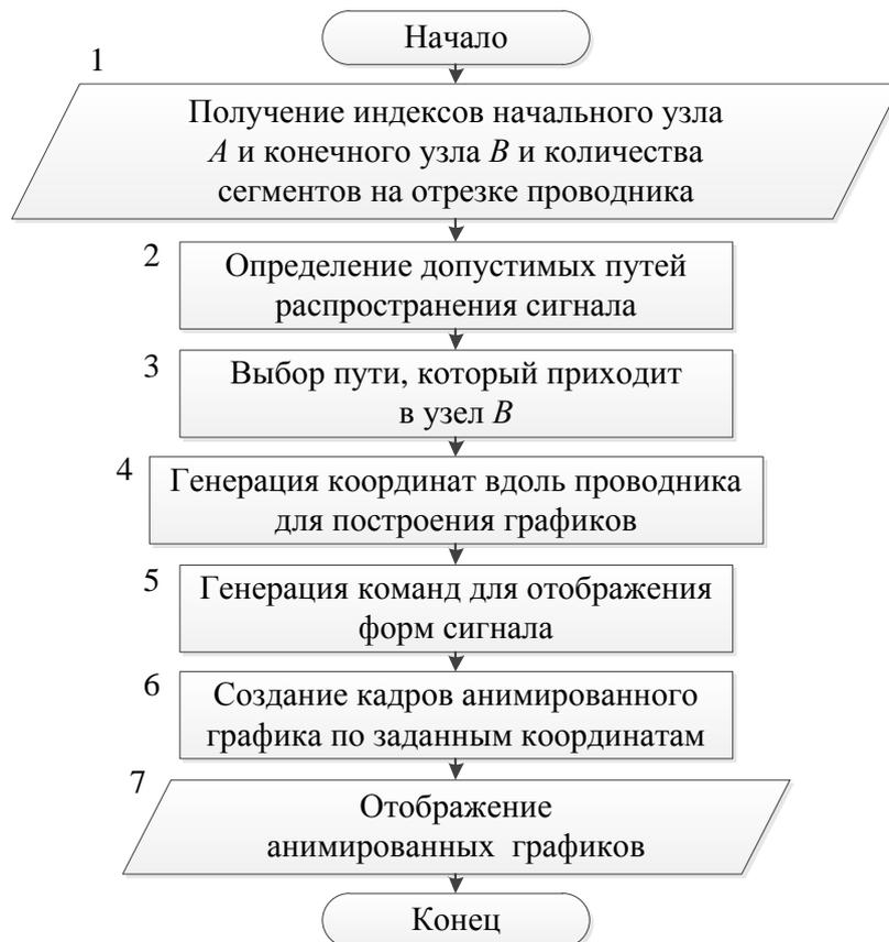
Рис. 2. Алгоритм визуализации распространения сигнала по цепи
