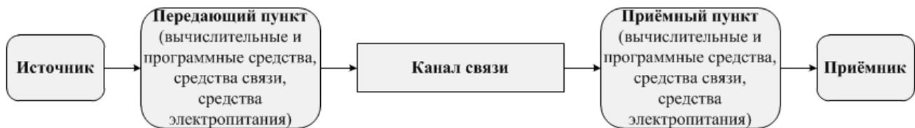
Рис. 5. Тракт передачи информации (пример)
