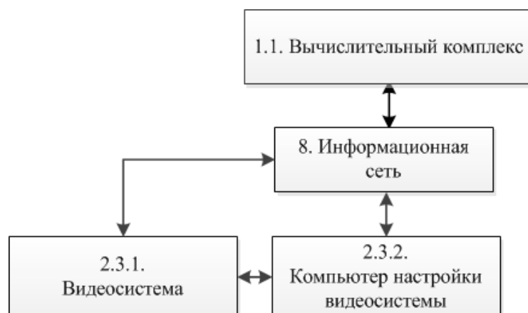
Рис. 5. Тракты передачи данных – с видеоизображениями, между вычислительным комплексом и видеосистемой (пример 1)
