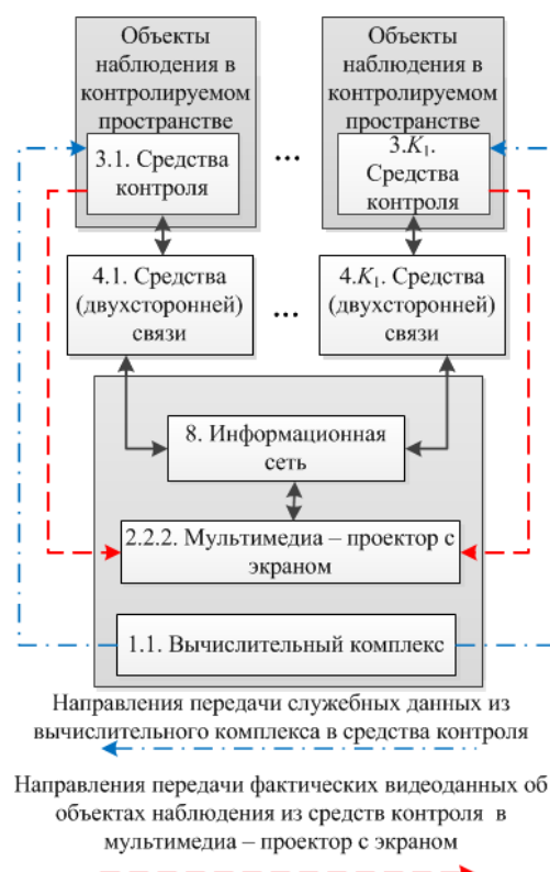
Рис. 8. Тракты передачи данных – с видеоизображениями между средствами контроля и мультимедиа – проектором с экраном (пример 4)
