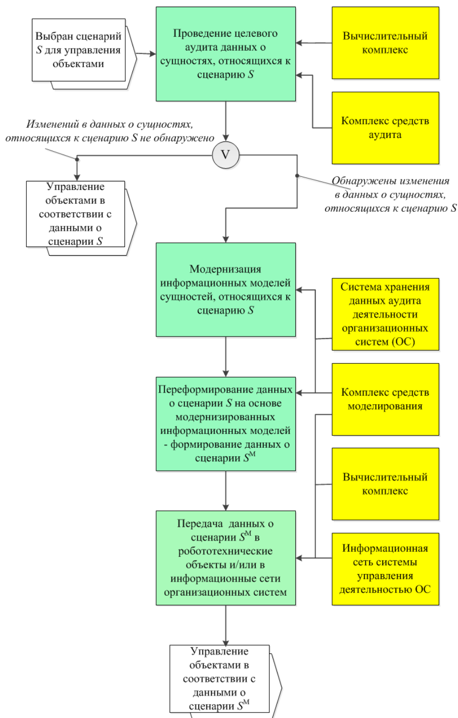
Рис. 4. Граф-схема алгоритма управления объектами (робототехническими объектами и другими объектами наблюдения) с учётом результатов проверки актуальности данных
