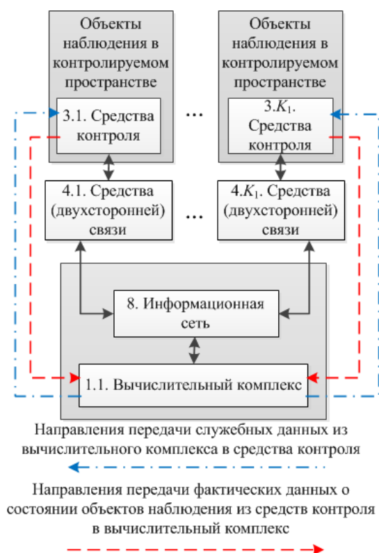
Рис. 7. Тракты передачи данных – с исчисляемыми показателями, между средствами контроля и вычислительным комплексом (пример 3)
