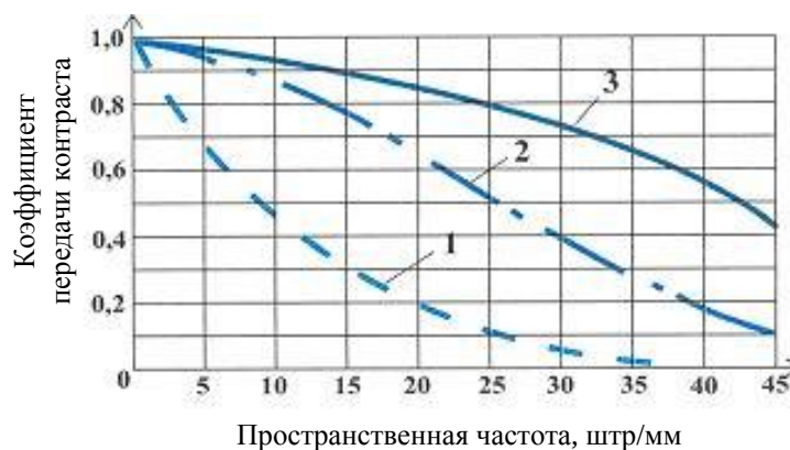
Рис. 14. Типичные кривые передачи контраста для: традиционных ICCD (кривая 1), EBCCD (кривая 2) и матрицы ПЗС (кривая 3)
