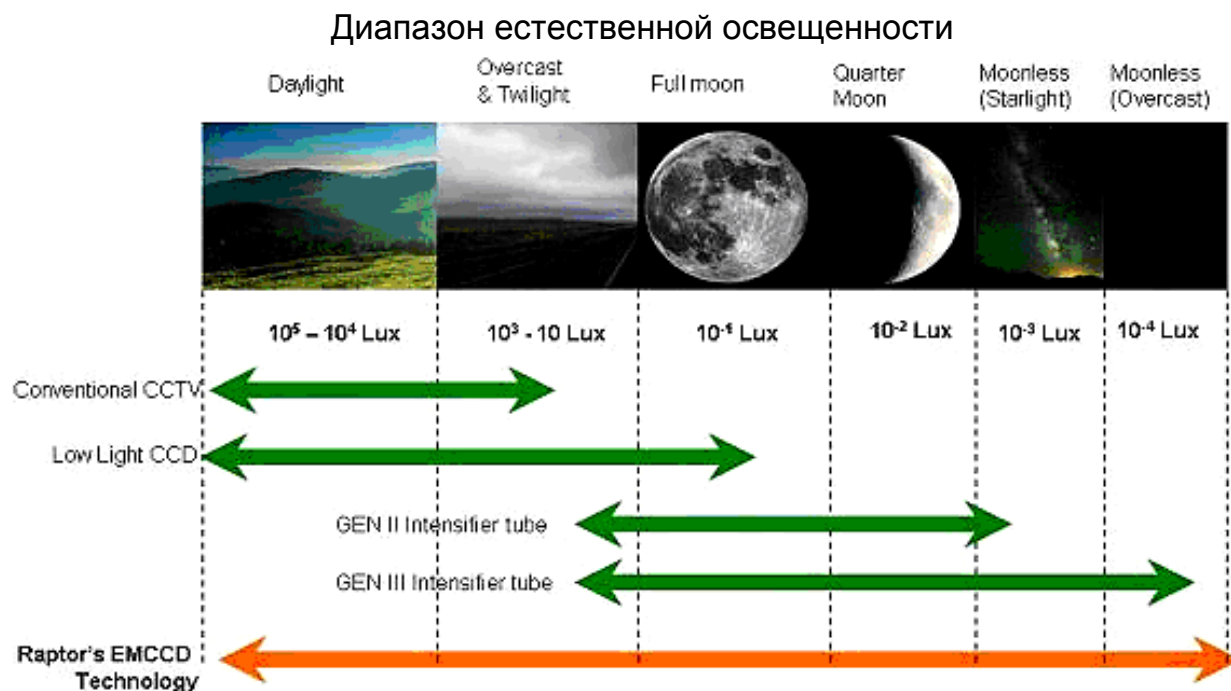
Рис. 20. Возможности EMCCD по сравнению с другими описанными выше устройствами с точки зрения работы при пониженных уровнях освещенности.
