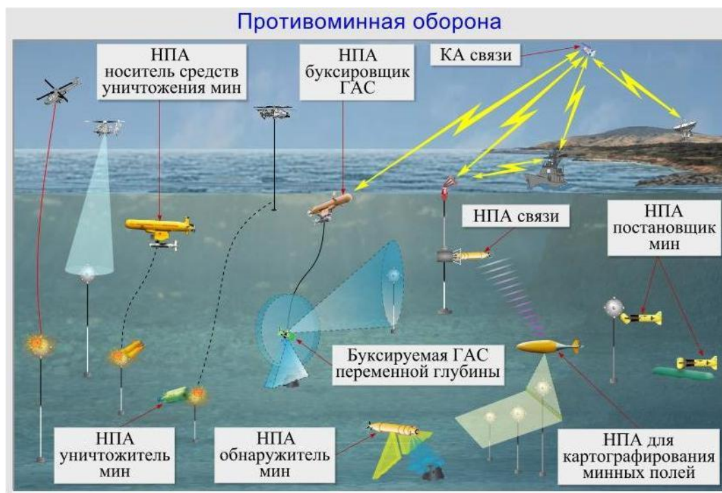
Рис. 6. Применение НПА для поиска и уничтожения мин [31, 37]
