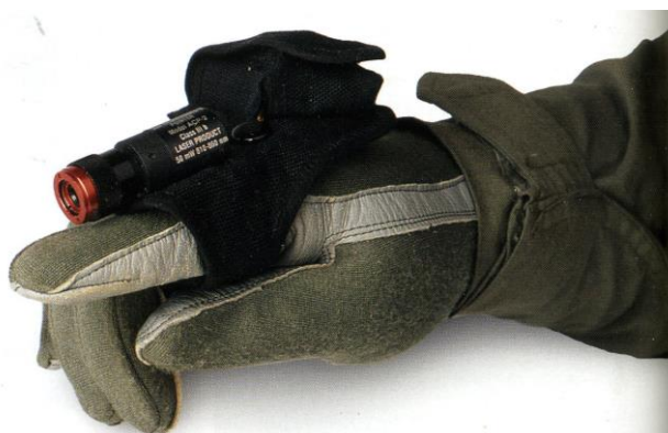
Рис. 15. ЛЦУ, надетый на палец, служащий для указания места посадки вертолета в ограниченных условиях видения
