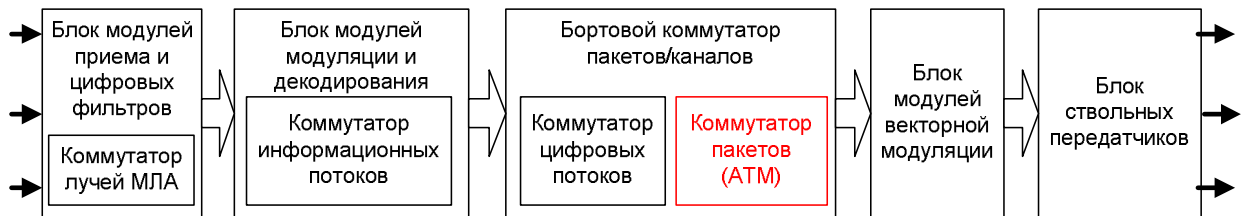
Рис. 1.3 – Схема бортового ретранслятора с ОСБ
