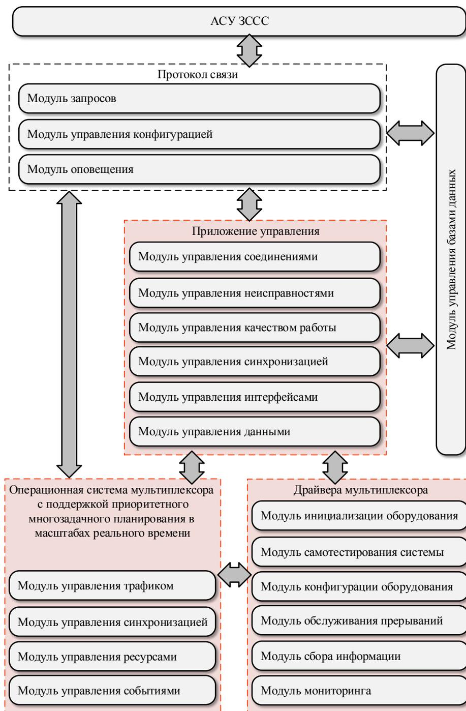
Рис. 23. Структура СПМО адаптивного мультиплексора ЗССС
