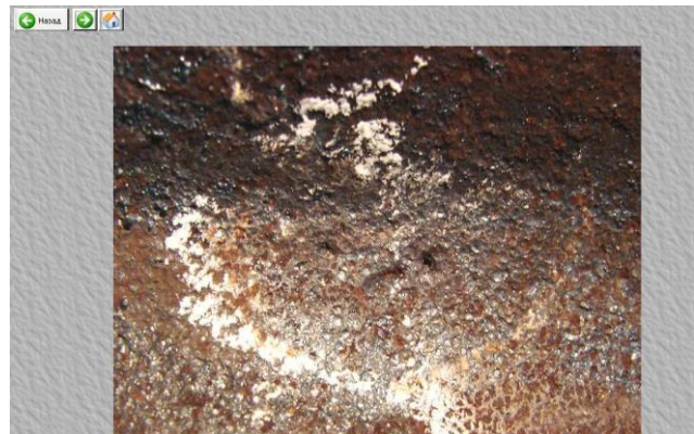
Рис. 6. Увеличенное место возникновения течи отливки
