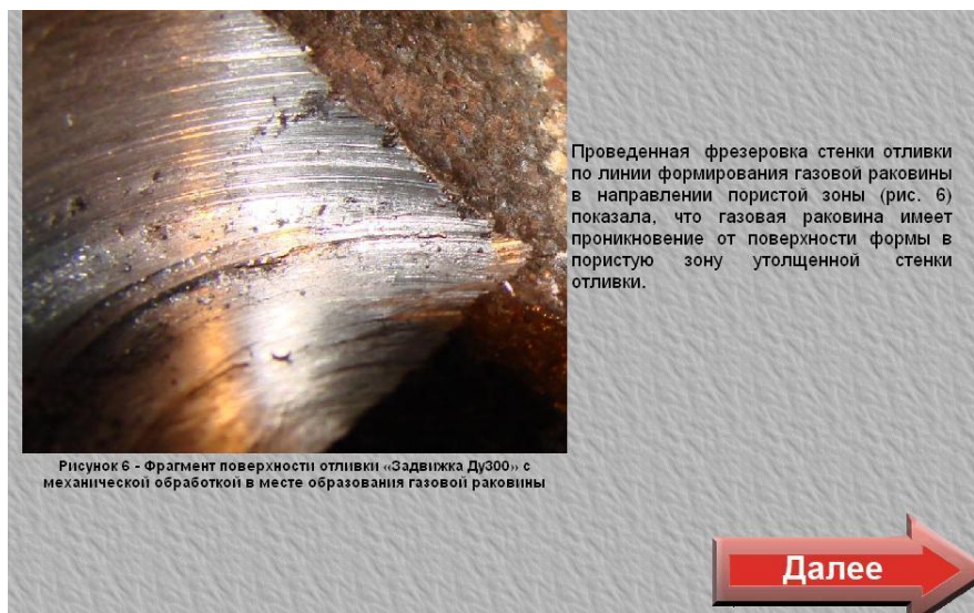
Рис. 7. Механическая обработка в месте образования газовой раковины
