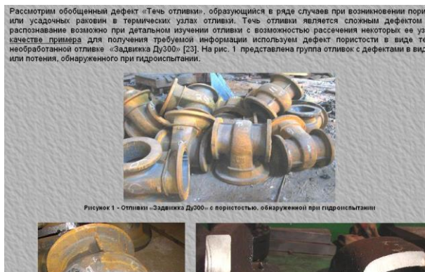
Рис. 5. Исследуемые отливки с дефектом течь
