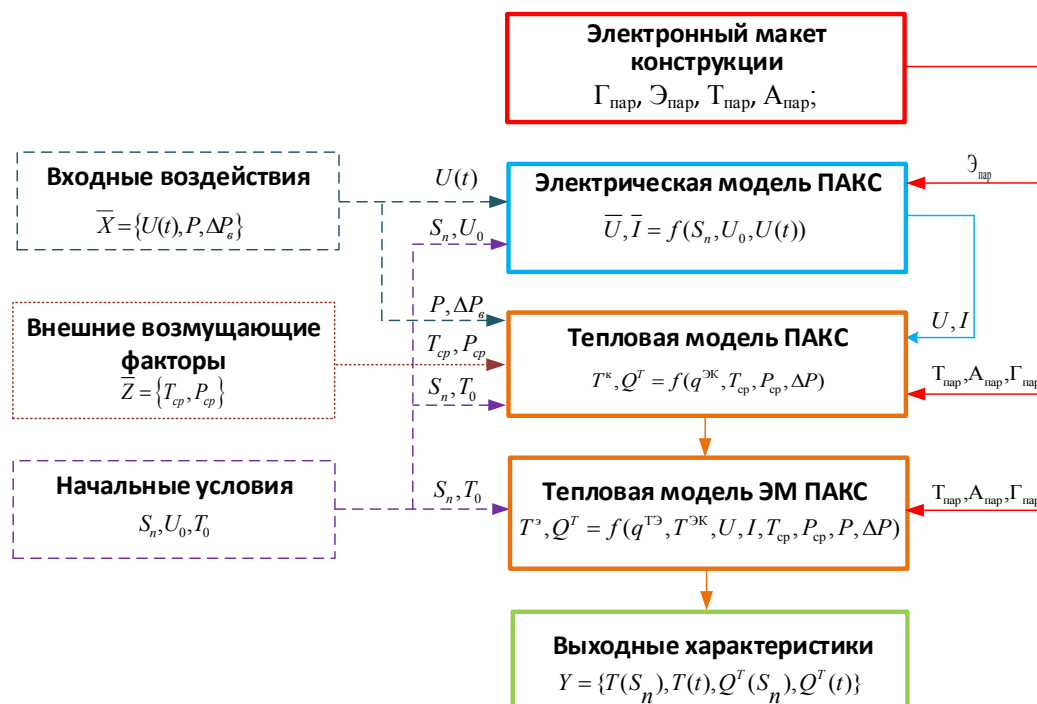
Рис. 3. Схема метода теплового комплексного моделирования ПАКС с учетом, электрических, тепловых и аэродинамических факторов
