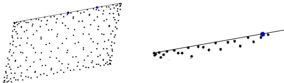
Для снижения влияния указанной методической ошибки предлагается увеличивать выборку отсчетов сигналов (рис. 6 а) и выполнять так называемую гистограммную обработку, т. е. разбивать массив M на K интервалов \Delta\varphi_k одинаковой длины \Delta\varphi и в каждом из них находить максимальное r_{\max} и соответствующее ему \varphi_k , k = \overline{1, K} (рис. 6 б).
