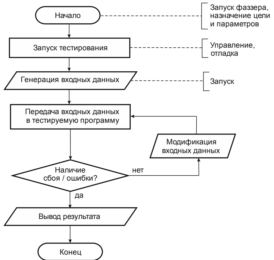
Рис. 1. Упрощённый алгоритм работы фаззера
